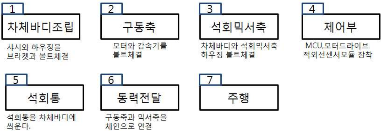
그림 6-1 로봇 라인기 조립 순서
