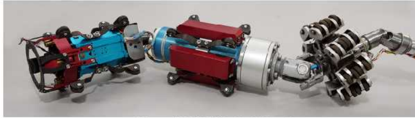
지름 10cm 배관 내부 결함 비파괴 검사 로봇
